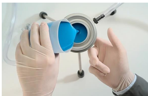
а) Закройте сопло. Начните наливать внутрь воронки тестируемую жидкость
