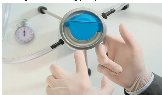
в) Уберите излишек жидкости. Откройте сопло и одновременно включите секундомер
