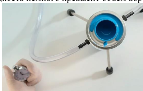
г) Остановите секундомер, когда поток прервётся в первый раз. Повторите измерения три раза, каждый раз с новым образцом того же самого материала
